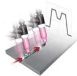
Voor het instellen van het verloop van minimaal naar maximaal vermogen bij TIG pulse lassen.
