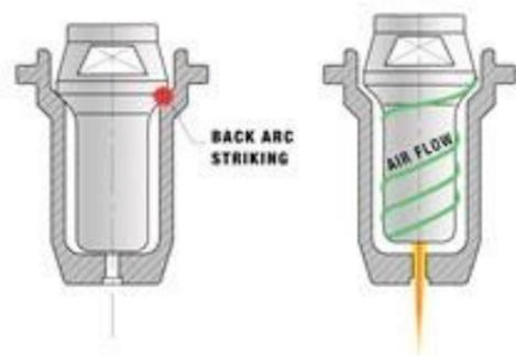
Tecnología "Back Stricking" para cebado de arco, al no utilizar Alta Frecuencia no daña componentes electrónicos.
