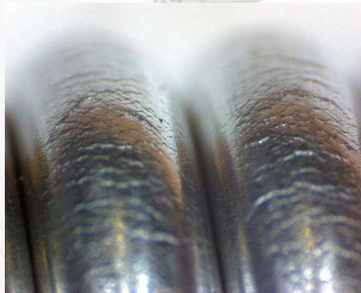
Competitor ER 5356 1.2 mm, Mandrel test
