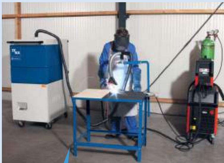
*ejemplo de utilización: CARTMASTER MV con manguera de aspiración y boquilla de embudo*
