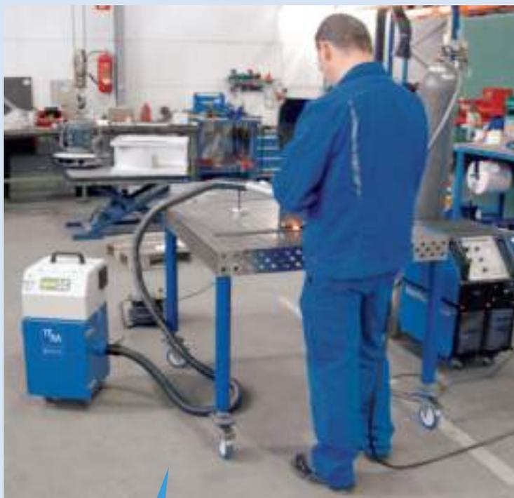
Ejemplo de aplicación: versión con turbina de rotación continua, con manguera y tobera de aspiración
