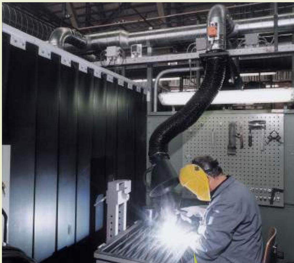
Ejemplo de aplicación: Brazo telescópico de aspiración en cabina de soldadura
