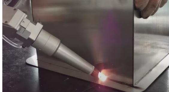
La tecnología láser muy versátil, se puede aplicar en el corte y grabado, el marcado láser, incluso en la limpieza. La **soldadura láser** cada vez está más presente en distintas industrias y se puede usar en superficies metálicas, de acero inoxidable u otros procesos de soldadura en industrias. Puede sustituir la soldadura por arco tradicional, soldadura eléctrica, plato de acero inoxidable, placa de hierro, placa de aluminio i la soldadura de otros materiales.
