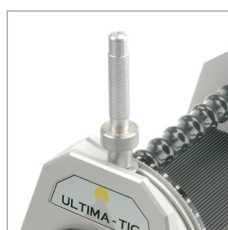
La punta se puede aplanar 1/10 mm por punto en la posición de 90°.
