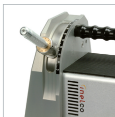
Afila el electrodo en el ángulo deseado
