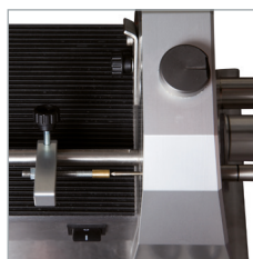
Selecciona la longitud del corte
